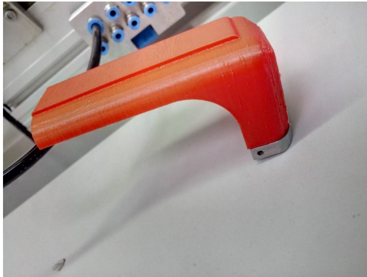
Gedruckte Traktormotorhaube aus PLA Kunststoff
