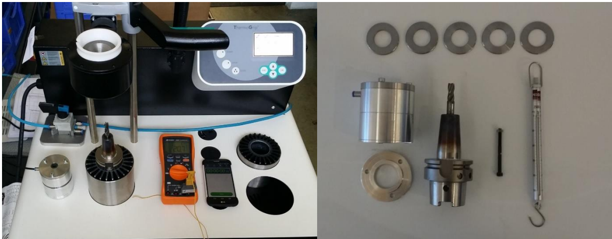
Versuchsaufbau zum Messen des Kühlverhaltens und Kraftverlauf
